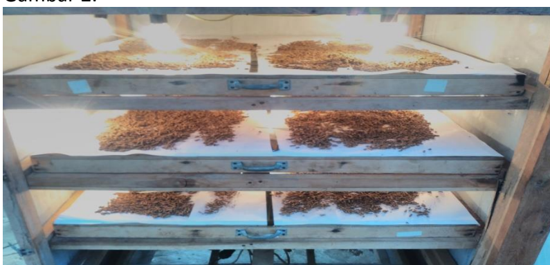
Gambar 2. Pengeringan Pelet Menggunakan Oven dengan Lampu Sebagai Sumber Panas
